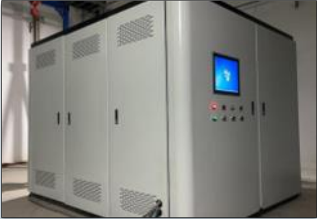
50kW SOFC发电装置
